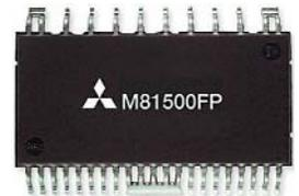
Модули M81500FP требуют минимального числа внешних пассивных компонентов — только трех: керамического бутстрепного конденсатора, шунтового резистора типоминимала 1206 и керамического конденсатора для подключения к выводу питания. Поскольку все входные логические терминалы совместимы с логикой 3 и 5 В, M81500FP можно напрямую подключать к микроконтроллеру или к цифровому сигнальному процессору.
