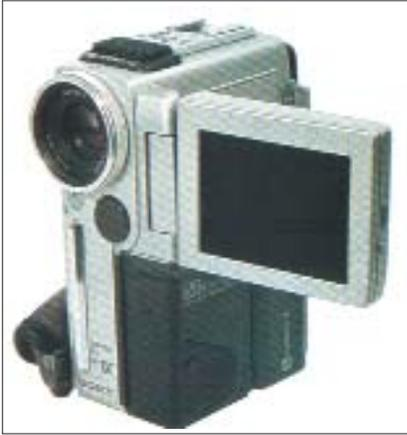
Рис. 3. Внешний вид miniDV-камеры «Sony DCR-PC3E»
