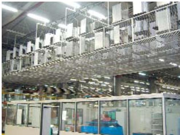
Транспортер корпусов стиральных машин
