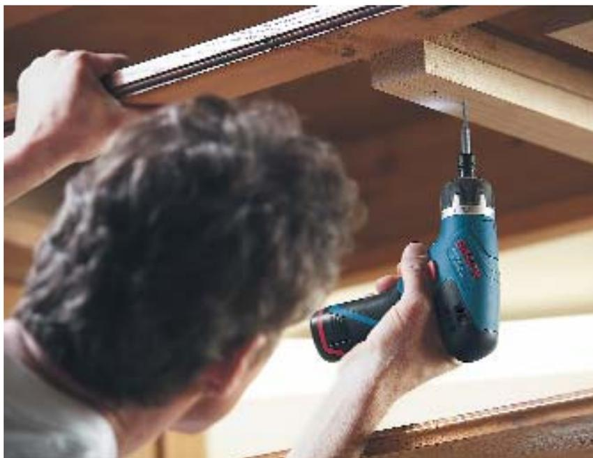
зоваться для сверления дерева и металла диаметром до 10 мм.
