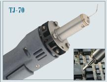
торов, которые разрушаются при контакте с горячим паяльником. Безопасной скоростью нагрева керамики от комнатной температуры считается 5°С/с. Такой плавный нагрев можно выполнить либо горячим воздухом, подаваемым с помощью минитермофена ТЈ-70, либо термоимпульсным пинцетом, кстати, тоже выпускаемым фирмой РАСЕ.
