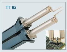
тщательно облудить припоем. После отпайки выводов компонент удерживается механическим захватом и удаляется с платы. Вся операция занимает 2-3 с, и поскольку непосредственному нагреву подвергаются только выводы компонента, а корпус нагревается уже от них, компонент не успевает перегреться. Последнее обстоятельство выгодно отличает данное приспособление от часто применяемого в таких случаях фена, нагревающего до температуры плавления все, что попадает под воздушную струю.
