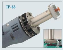
Если корпус крупнее (от 64 до 208 выводов), то поверхностного натяжения недостаточно для его подъема. В этом случае применяют термоэкстрактор ТР-65. Внутри его наконечника имеется присоска, подключенная к вакуумной системе паяльной станции. После отпайки выводов компонент удаляется с платы с помощью вакуумного захвата.
