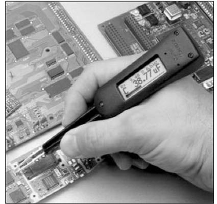
идентификации деталей в формате SMD. Устройство незаменимо при отладке сложных экспериментальных схем и ремонте электронной аппаратуры. ST автоматически выбирает наиболее подходящий режим измерения и его диапазон, позволяя оператору полностью сконцентрировать внимание на измеряемой схеме, значительно повышая при этом эффективность работы.
