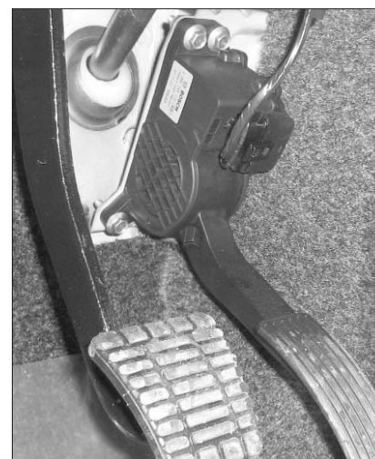
Рис. 2. Внешний вид электронного акселератора НАЗ-3163 «Патриот»
