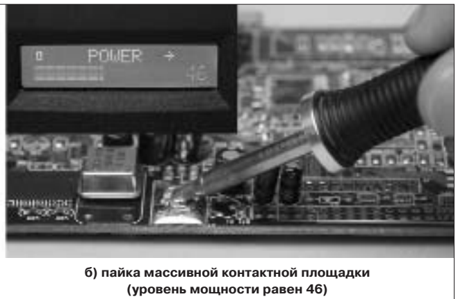
Рис. 5. Чем больше теплоемкость паемого контакта, тем большую мощность выдает «динамический» паяльник
