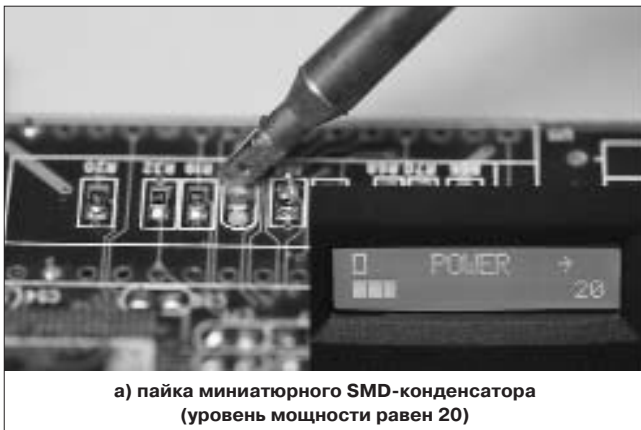
Рис. 5. Чем больше теплоемкость паемого контакта, тем большую мощность выдает «динамический» паяльник
