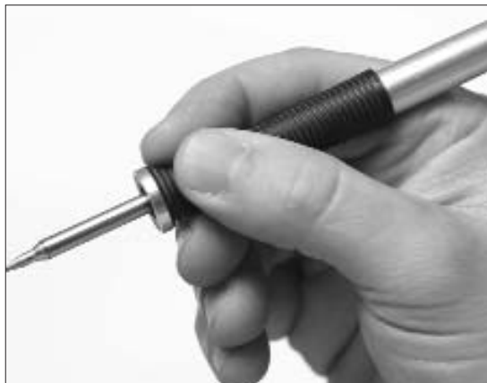
Рис. 1. «Динамический» паяльник отличается небольшим весом и размером наконечника, и как следствие — прекрасной эргономикой
