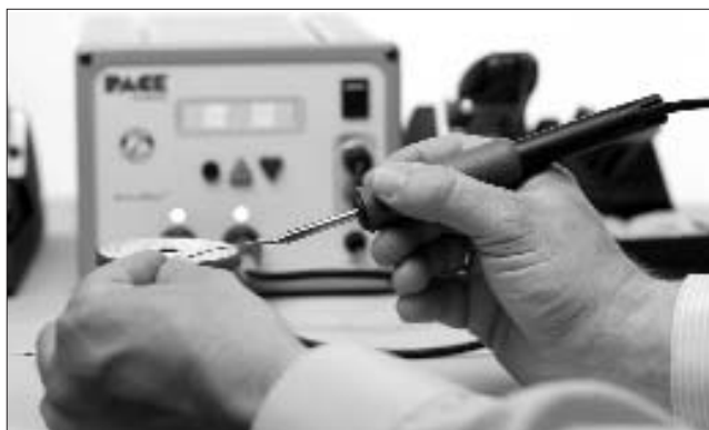
Рис. 7. «Динамический» паяльник «PACE TD100» с наконечником «миниволна»
