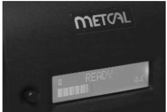
Рис. 4. Индикатор мгновенной мощности станции «METCAL MX-5000»
