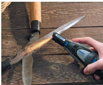
Рис. 2. Заточка садовых ножниц с помощью Dremel 300 Series
