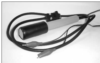
Рис. 7. Датчик МВС к прибору ПУНС-5 для проверки статоров
