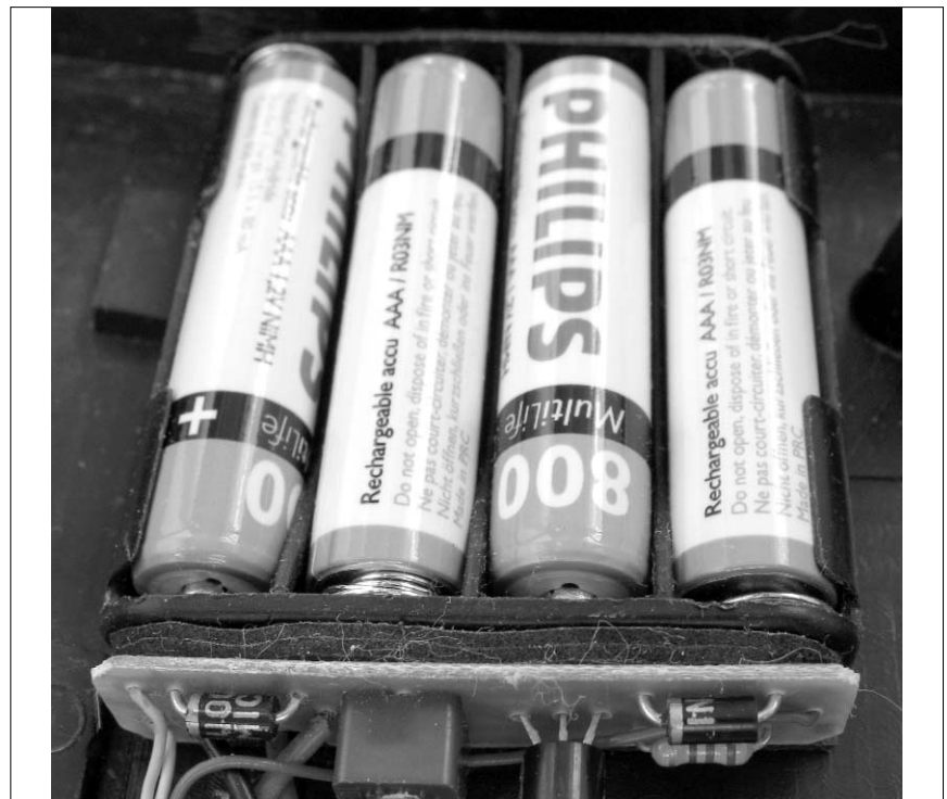
Рис. 4. Внешний вид устройства резервного питания
