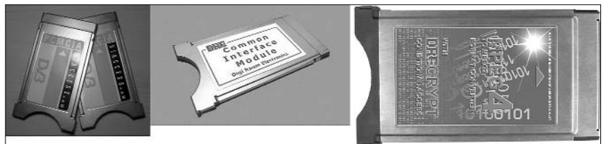
Рис. 2. CAM-модули VIACCESS RED CAM, DRE CI MODULE и MP4 to MP2 CONVERTER WITH DRECRYPT CAS
