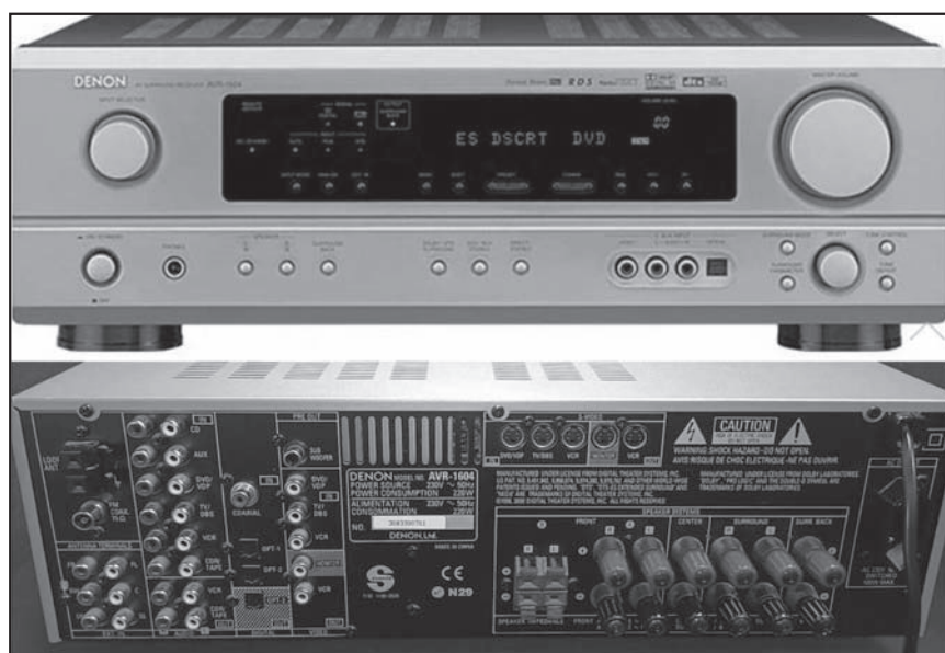
Рис. 1. Внешний вид AV-ресивера AVR-1604
