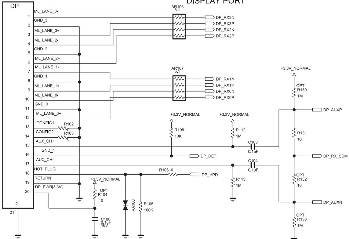
Рис. 7. Фрагмент схемы основной платы с двумя интерфейсами HDMI и портом дисплея DP (DisplayPort)
