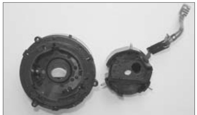
Рис. 3. Компоненты системы выдвигающихся колец
