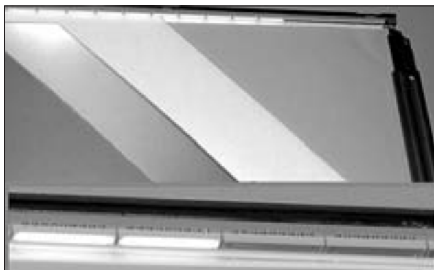
Рис. 1. ЖК панель с краевой подсветкой (Edge-LED)
